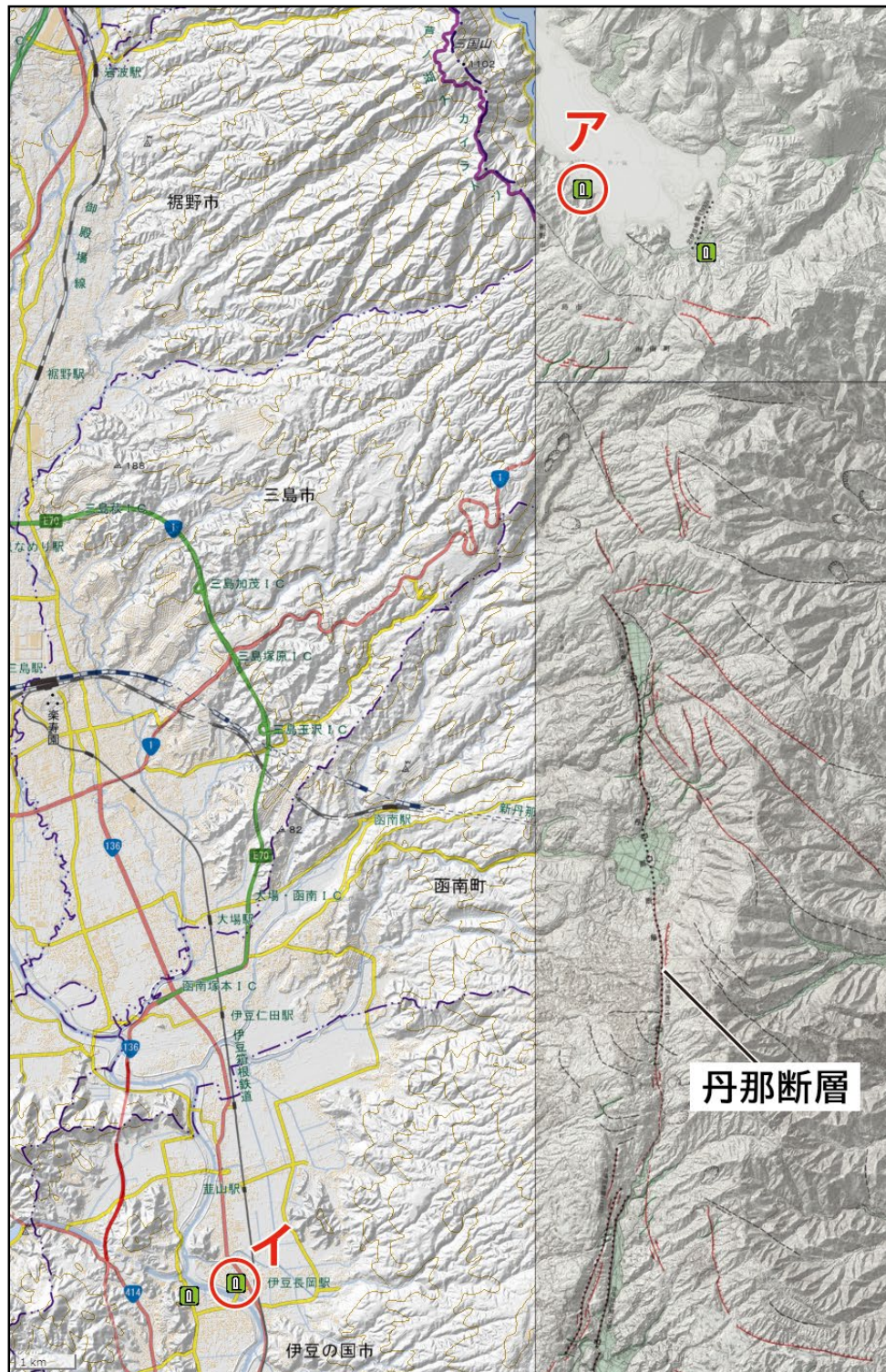
図 静岡県函南町とその周辺の陰影起伏図に活断層図を重ねて表示
